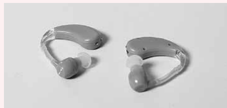
補聴器の一例（写真は耳かけ型）
