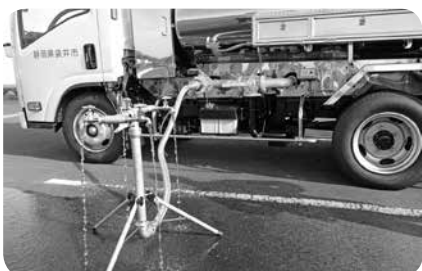
積載量3トンの給水車
