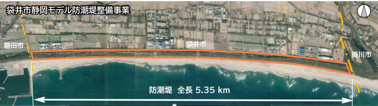
▲市の沿岸部(5.35km)に、標高12mの防潮堤を県と連携して整備(2015年から整備を開始し、2025年6月完成)
