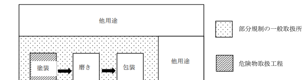
第5-3図 複数の設備を一部の部分規制の一般取扱所として規制する例
