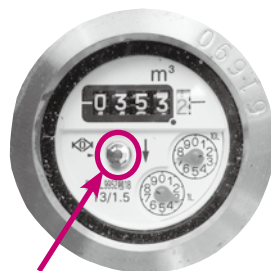
パイロット (回っていれば使用中)
