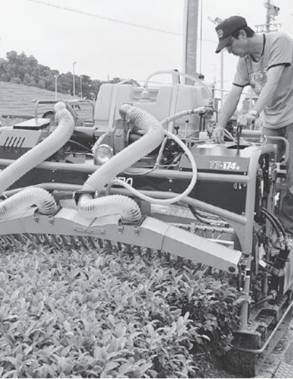
風圧と水滴で害虫の防除を行う機械
