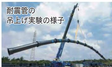
耐震管の吊上げ実験の様子 (写真提供: 日本ダクタイル鉄管協会)
