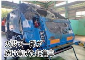
3月中旬、資源ごみ「金物・小型電化製品」を収集中のごみ収集車1台が燃える事故が発生しました。現場の状況から「リチウムイオン電池」または「リチウムイオン電池」が原因と見られています。
