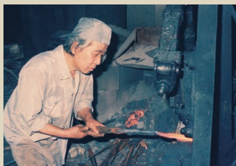
加熱した鉄と鋼を重ねハンマーで叩いて形を作る
