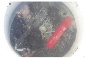
[写真] 消火後に水に浸けた様子
