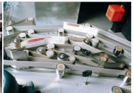
製販一体となって高品質な製品を提供 郵便局における手紙・封筒搬送ベルト
