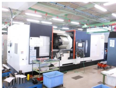
大型 NC 旋盤 (マザック STN500) 大物ワークを加工できる設備を多数保有しています。
