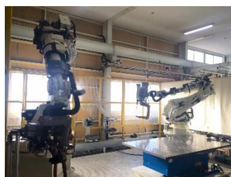
ロボット溶接機
