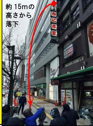
2015年2月、札幌市内の飲食店ビルの外壁に取付けられた看板の一部が落下し、歩道を通行していた女性の頭部に当たり重傷を負わせる事故が発生しました。外壁への取付け部品が腐食したことによる強度低下と、強風の影響で落下したものとみられています。
