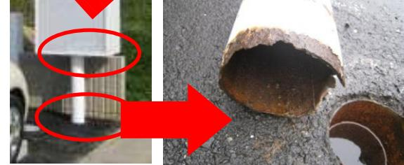
↑柱根元のサビを放置し、倒壊。
