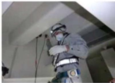
●超音波探傷法による亀裂検査
