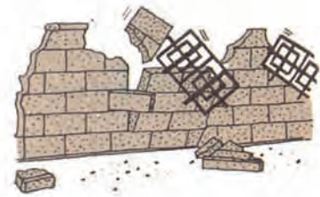
鉄柵の入ったブロック
