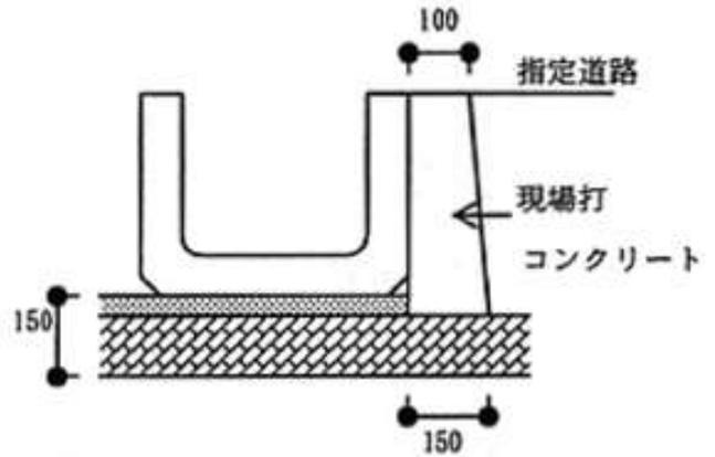
U型側溝(コンクリート2次製品)
