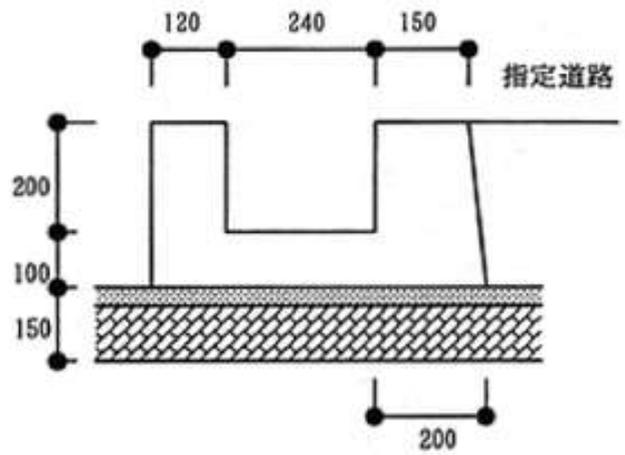
L型側溝(コンクリート二次製品)
