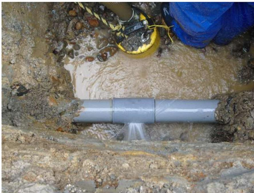
写真1 老朽化による漏水事故(市内某所)
