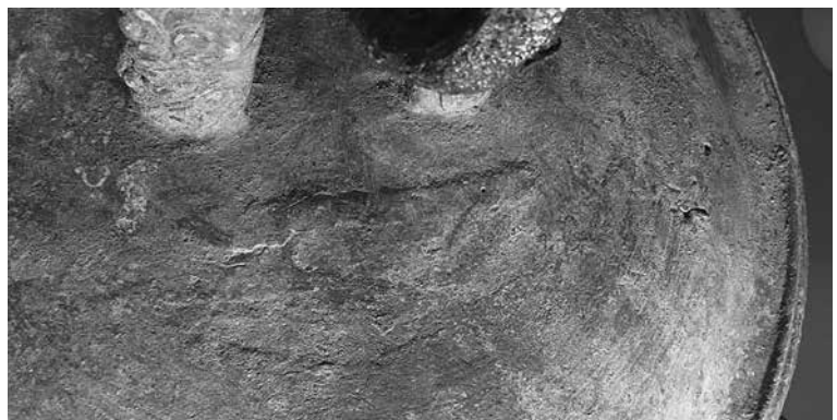
図 16 笠形上面の湯口
