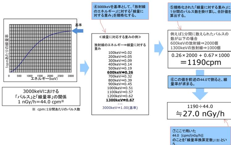
(注) 線量率換算定数は、検出器の仕様により異なり、本県では、通常型検出器では44.0cpm/(nGy/h)を、方向特定可能型検出器では40.4cpm/(nGy/h)を用いている。
