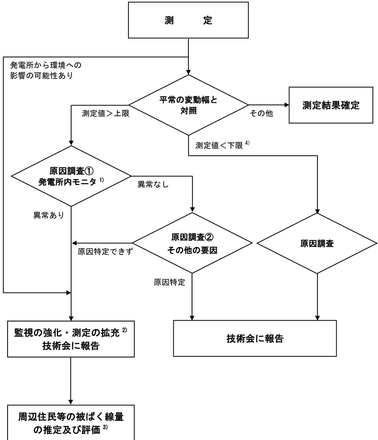
注 1) 発電所内の格納容器雰囲気モニタ、燃料交換エリア換気モニタ、モニタリングポスト等をいう。
